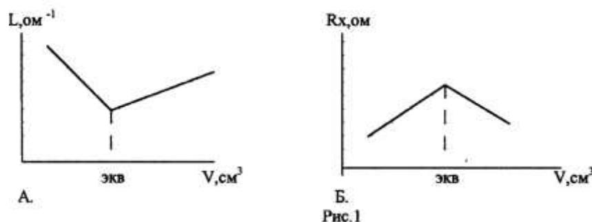
В ходе титрования в титруемом растворе уменьшается концентрация высокоподвижных ионов  $H^+$ , так как они связываются с ионами  $OH^-$  с образованием малодиссоциирующего соединения  $H_2O$ . Вследствие этого электропроводность  $L$  постепенно уменьшается до полной нейтрализации ( точки эквивалентности).
